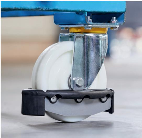
Las delanteras tienen una forma tal que se presionan hacia la rueda tan pronto como esta entra en contacto con el pie. Esto evita que la rueda se mueva y aplaste el pie.
