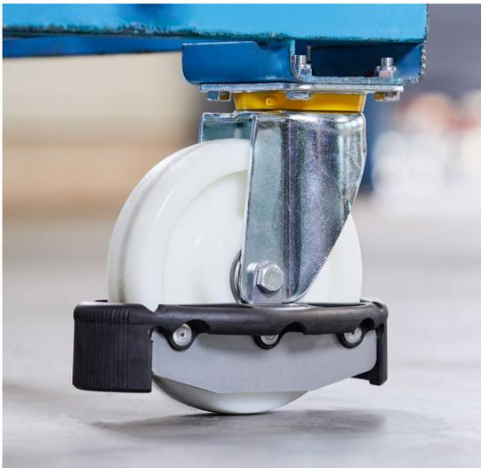
Schürzen aus Gummi mit einem Härtegrad von 80 Shore. Diese sind so geformt, dass sie zum Rad hin zusammengedrückt werden, sobald Rad und Fuß in Berührung kommen. Dadurch wird verhindert, dass der Fuß unter die Rolle gerät und Quetschungen erfährt.
